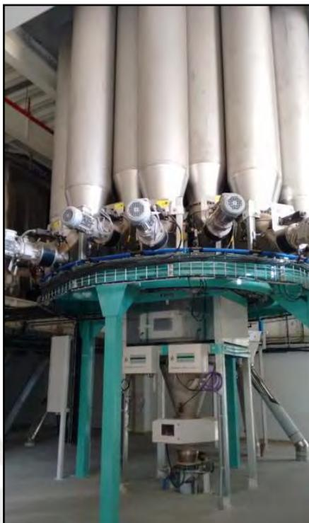
**Ilustración 19. Sistema de Dosificación de Micro-componentes – 20 silos de 600 litros para la línea blanca y medicada (6to piso de la torre)**
