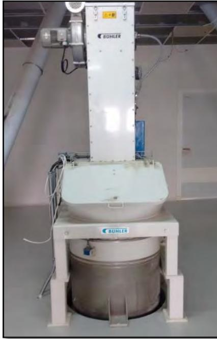
**Ilustración 20. Cabina de Carga para materia prima fraccionada, se repite en las tres líneas de producción (5to piso de la torre)**
