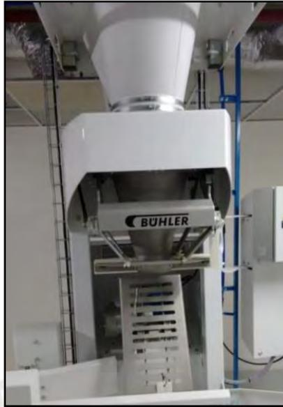
**Ilustración 24. Ensacadora MWPF, tanto en línea blanca y medicada (1er piso de la torre)**
