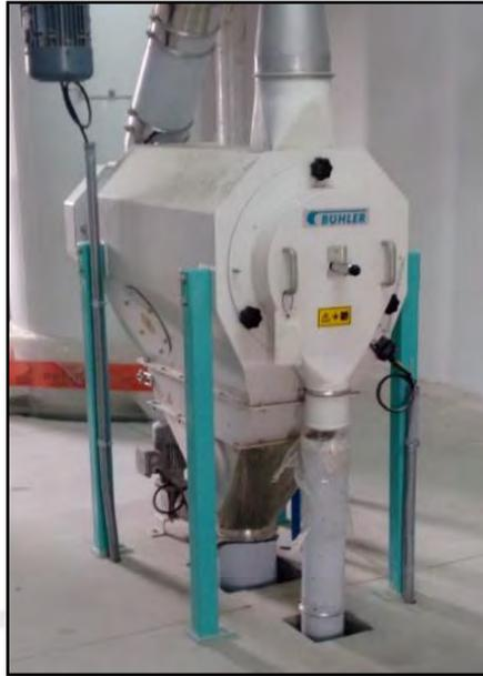
**Ilustración 22. Tamizadora Turbo-Star MKZF 40/90 E.**
