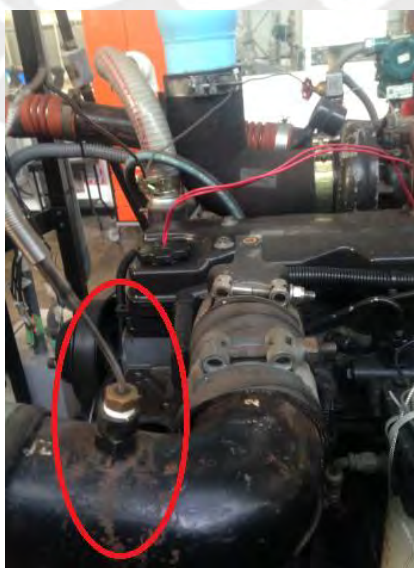
Figura 3.11 - Medida de la temperatura de admisión
