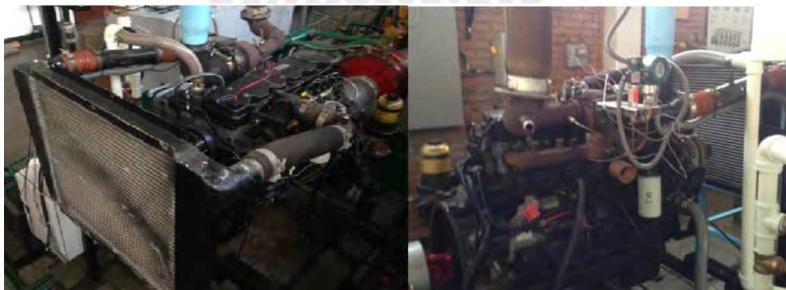
Figura 3.2 - Vistas frontal y posterior del motor Diesel turboalimentado Cummins, modelo QSB6.7
