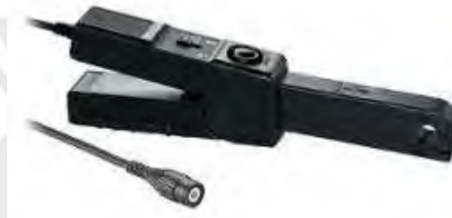
Figura 3.9 - Pinza de corriente activa utilizada en las pruebas
