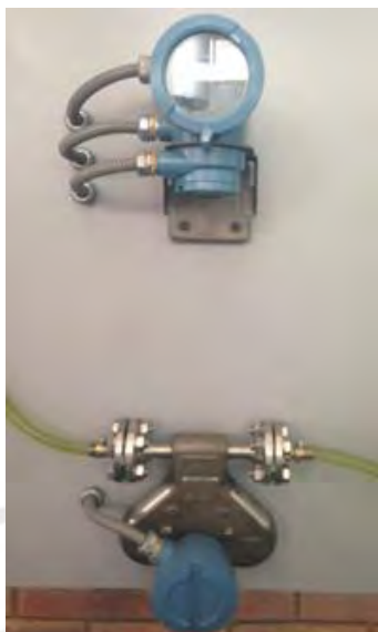
Figura 3.10 - Sensor de Coriolis para medir el caudal de combustible
