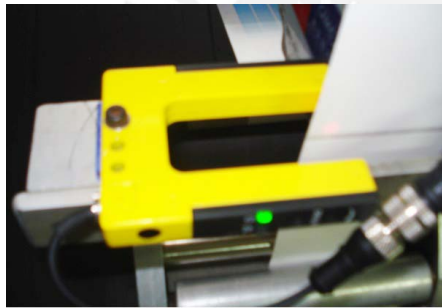
(a) Ubicación de la cinta con etiquetas a una distancia media entre los brazos del sensor
