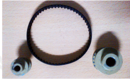
Figura 3.4: Correa dentada XL 116, poleas dentadas 13 XL037 y 21 XL037.
