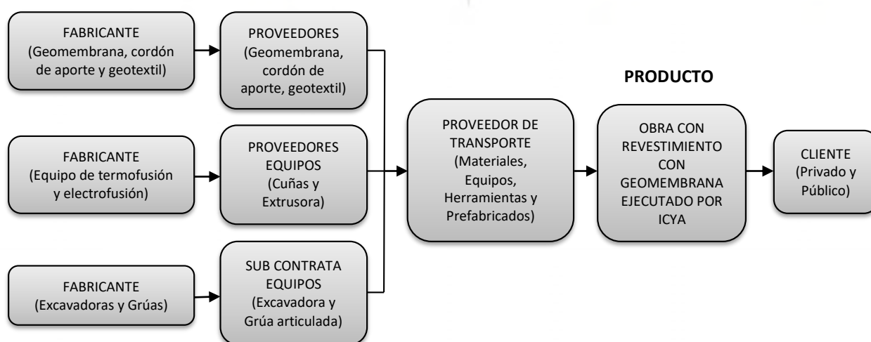
Figura 106. Cadena de suministro para obras con revestimiento de geomembrana HDPE
