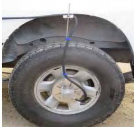
Figura 3.8. Odómetro acoplado al neumático trasero izquierdo del vehículo. ( Activa Ingeniería y Construcción, 2015 )
