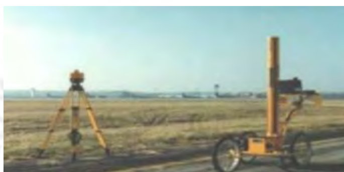
Figura 2.6. Nivel y mira para medición de IRI (Nava, 2007)
