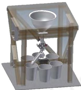
Fig. 1.7-Selector de Skittles y M&M
