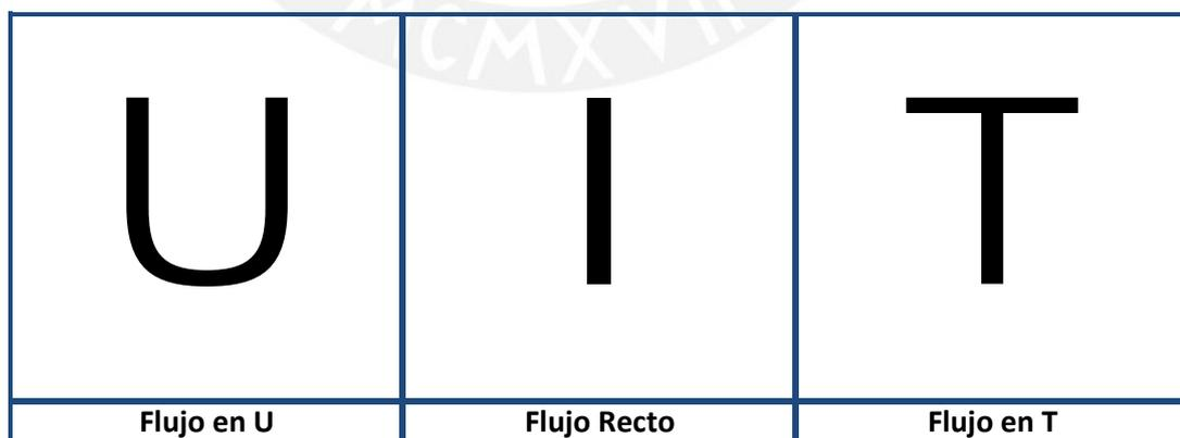
Figura 10. Tipos de distribución en planta de flujo de materiales
