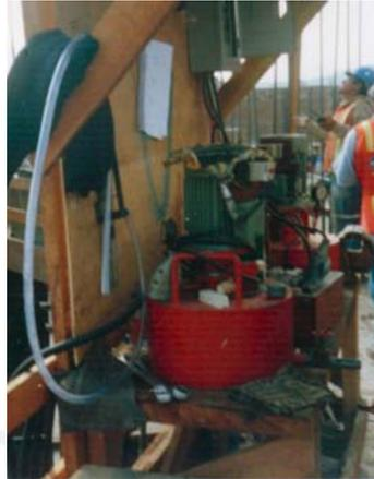
**Foto 3.3 Bomba hidráulica para distribución de aceite**
