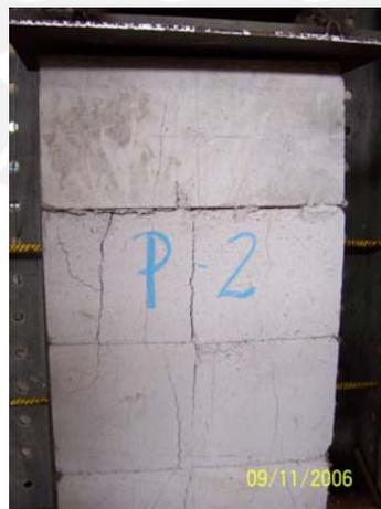
**Foto 4.10** Formación de grietas verticales en la pila
