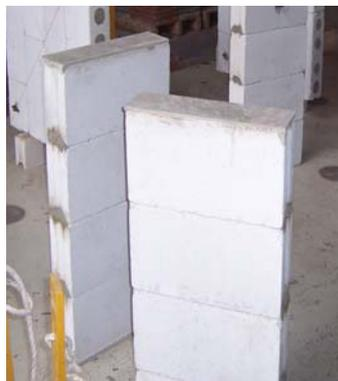
**Foto 4.6** Capping en la superficie de las pilas
