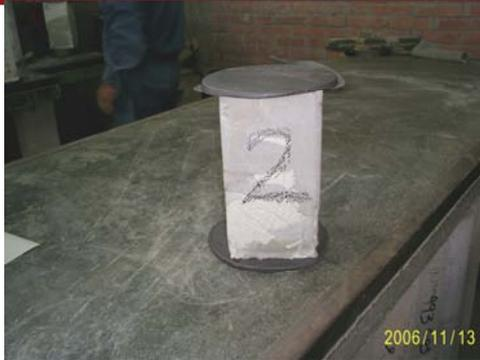
**Foto 3.4** Probeta prismática de grout con capping
