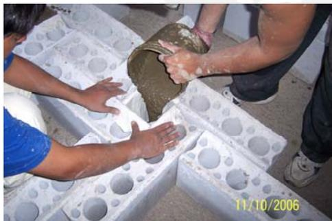
**Foto 3.2** Fabricación de probetas prismáticas de grout.
