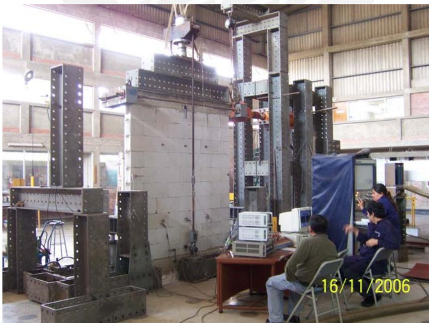
**Foto 6.4** Muro listo para ser ensayado
