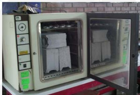
**Foto 2.3** Secado al horno de los bloques.
