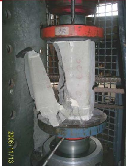
**Foto 3.6** Ensayo de compresión de la probeta de grout.
