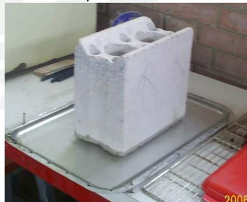
**Foto 2.5** Ensayo de succión.
