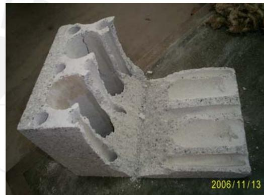
**Foto 2.9** Bloque P-14 después del ensayo a compresión.
