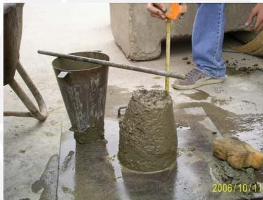
**Foto 5.10** Medición del slump
