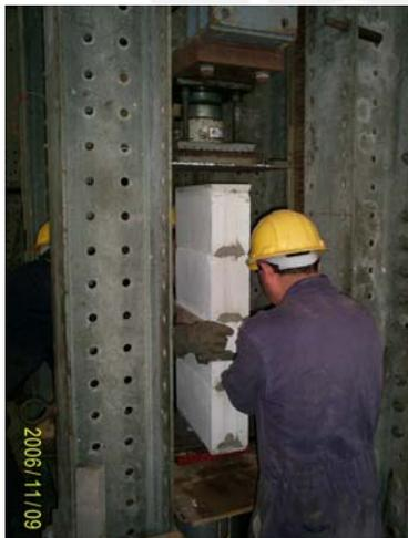
**Foto 4.1** Colocación de la pila para el ensayo
