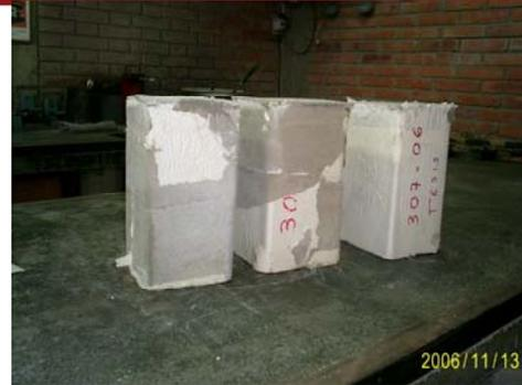
**Foto 3.5** Probetas prismáticas de grout.
