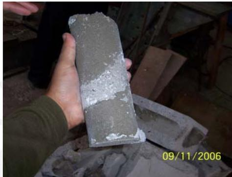
**Foto 4.13** Trozo de grout totalmente desprendido del bloque.
