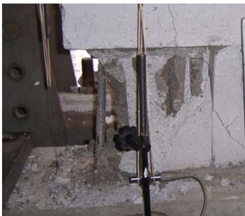
**Foto 6.6** Trituración del talón.
