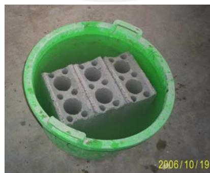
**Foto 2.6** Ensayo de absorción.
