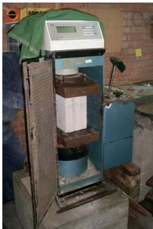
**Foto 2.8** Ensayo a compresión del bloque.
