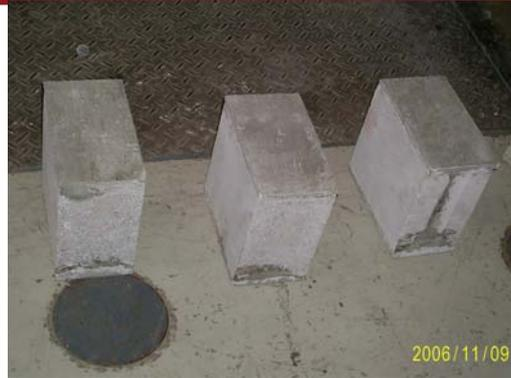
**Foto 3.7** Bloques P-14 rellenos de grout.
