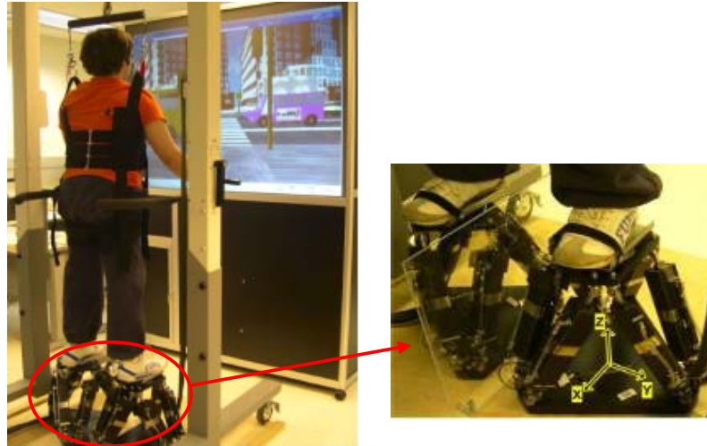
Figura 1.4: Simulador de marcha usando dos plataformas Stewart [Boia05].
