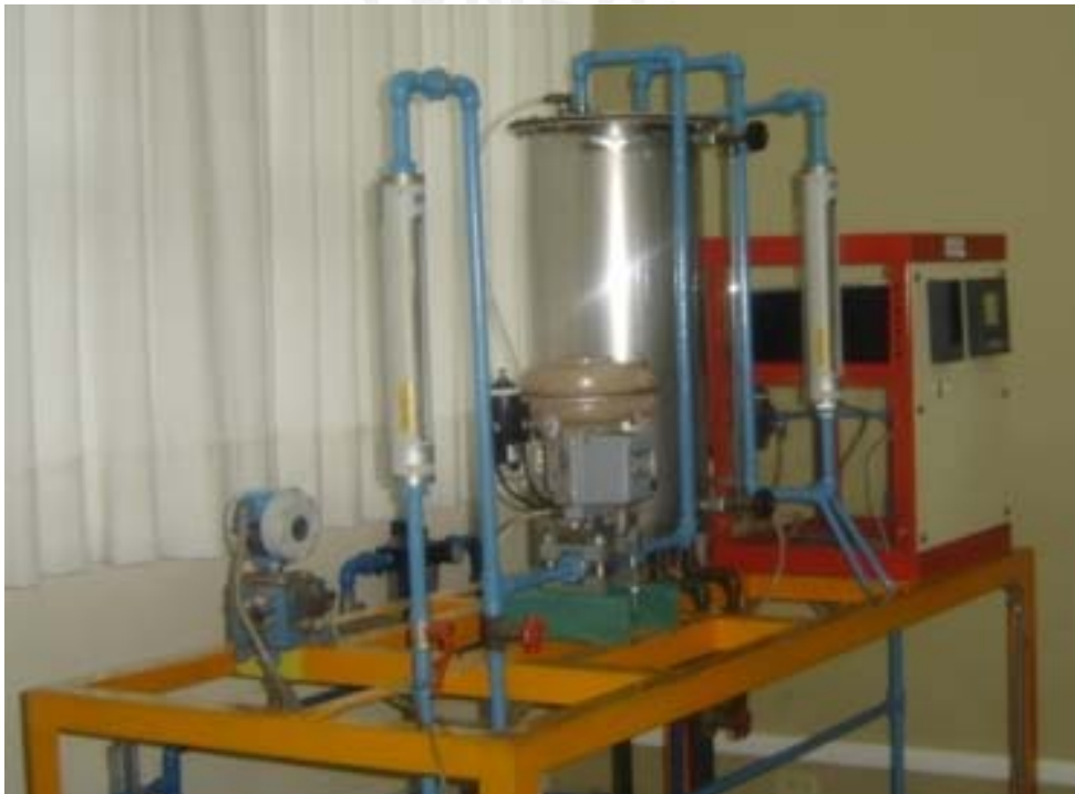
Figura 1.3 Planta Modelo de Presión, Laboratorio de Control y Automatización – PUCP.
