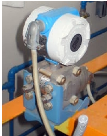
Figura 1.8 Vista del Transmisor de Presión de la Planta de Presión.
