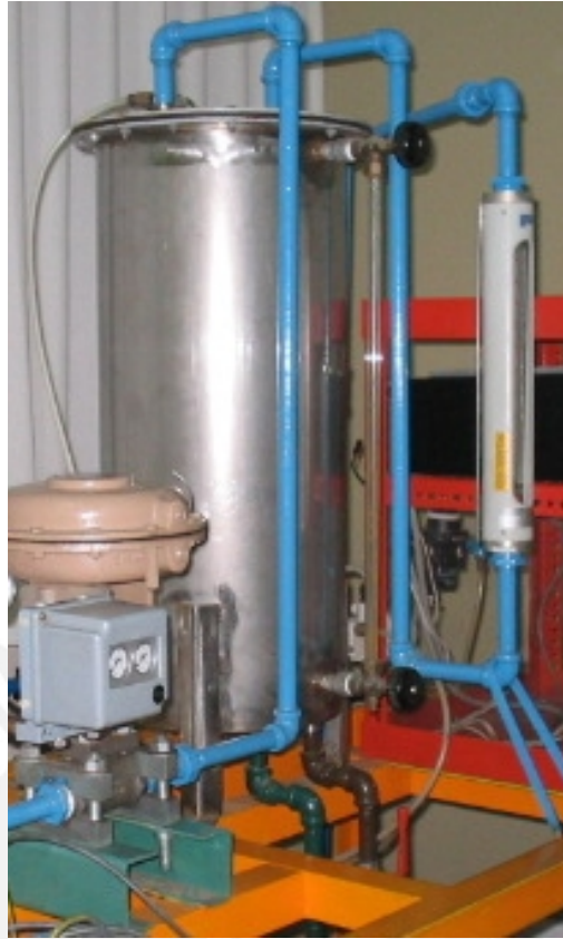
Figura 1.7 Vista del Tanque de Almacenamiento de la Planta Modelo de Presión.
