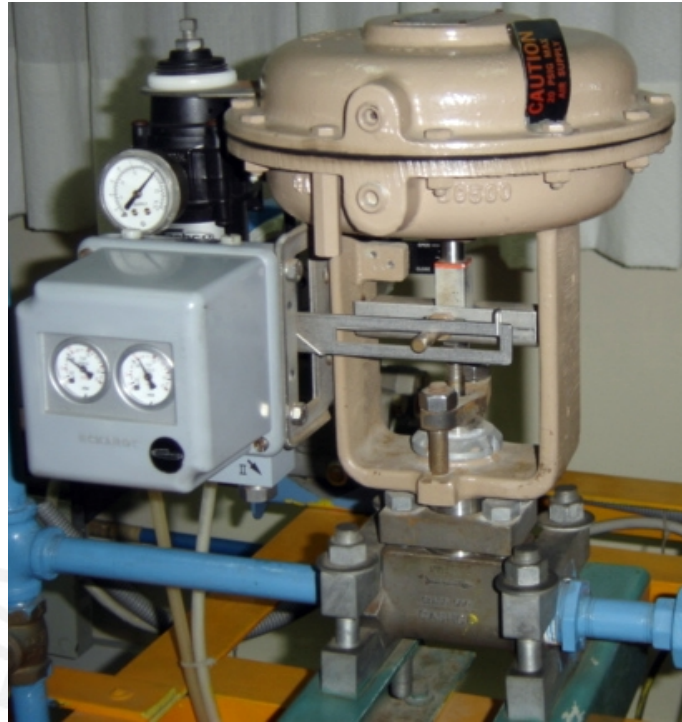
Figura 1.6 Vista de la Válvula de Control de la Planta Modelo de Presión.
