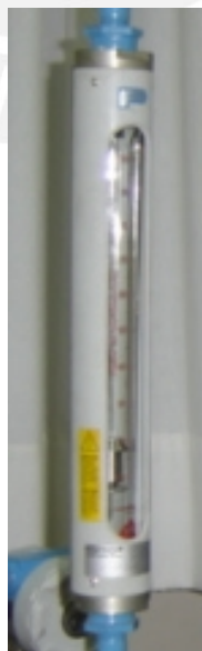
Figura 1.9 Vista del Indicador de Flujo de Aire.
