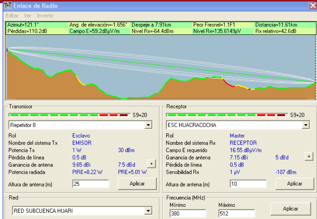
FIGURA 47. ZONA DE FRESNEL REPETIDOR 8 - ESC HUACRACOCHA
