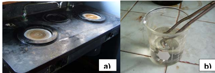
Figura 2.12. a) Equipo de pulido mediante paños y una solución de alúmina en suspensión b) Inmersión de la probeta en la solución de ataque metalográfico
