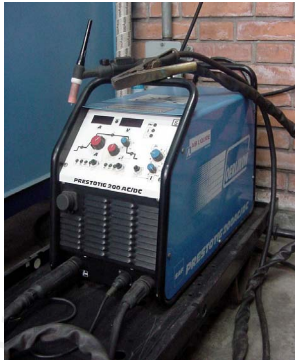
Figura 2.1 Máquina de soldar AIR LIQUIDE-SAF. Modelo: PRESTOTIG 300 AC/DC
