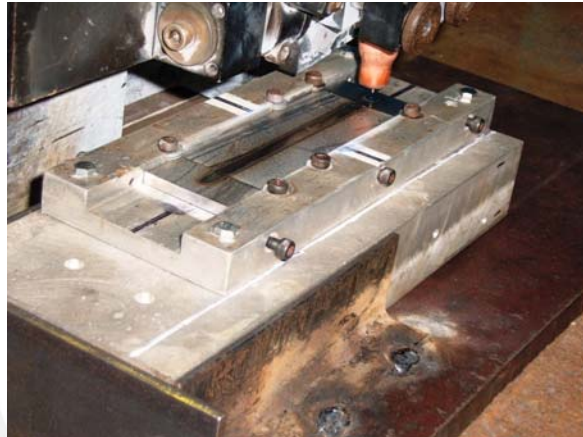
Figura 2.8 Enfriamiento después de terminado el proceso de soldeo
