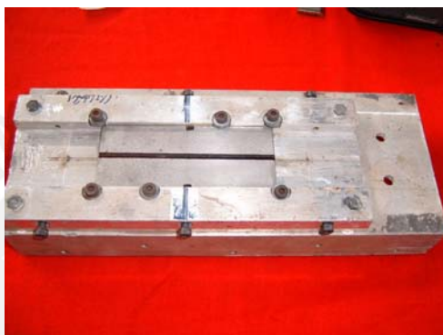
Figura 2.4 Base de aluminio para sujeción de la plancha a soldar
