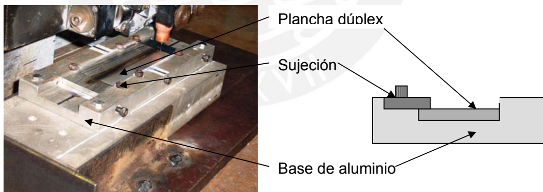
Figura 3.1 Esquema de la disposición de la plancha soldada y base de aluminio
