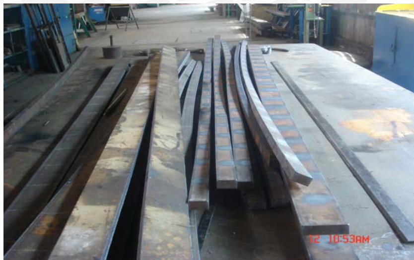
Foto 3.3: Los largueros de los carros se deforman, por la temperatura de trabajo 900 °C, y por perder espesor a causa de la abrasión
