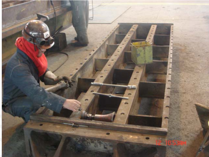
Foto 3.5: Verificación de las deformaciones del carro sinter con ayuda de una gata.
