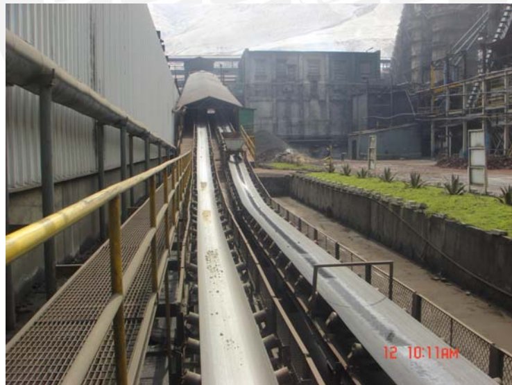
Foto 3.2: La faja Número 34 envía el sinter producido en aglomeración, hacia los hornos de manga.
