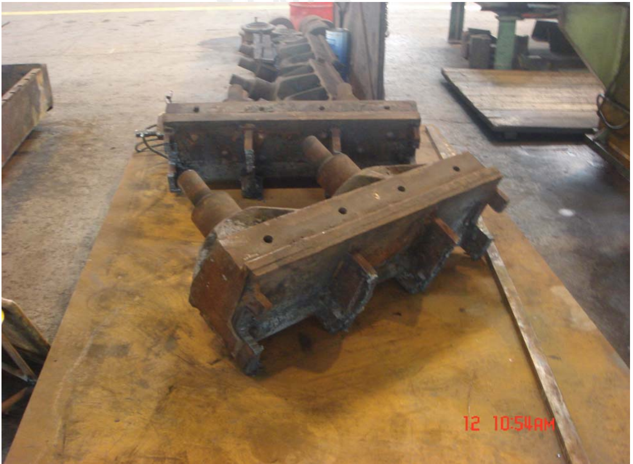
Foto 6: Lo único que se recupera de los carros sinter son los cabezales lo demás se deshecha, y se suelda largueros nuevos
