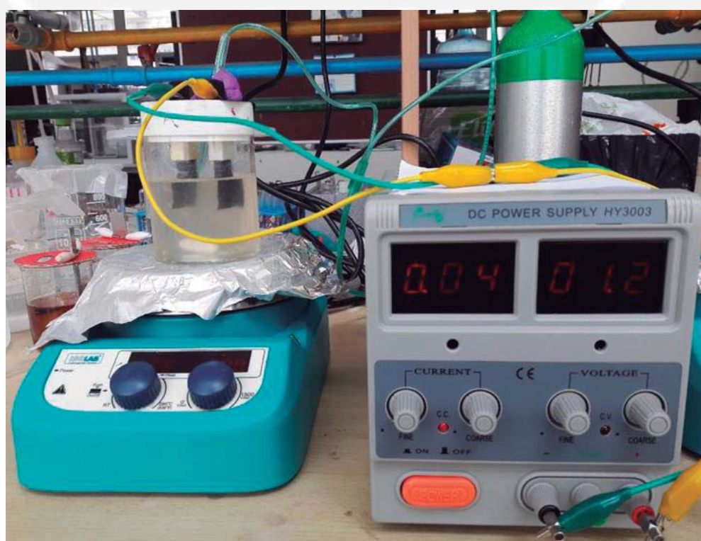
Figura 12. Tratamiento electroquímico del ácido palmítico en emulsión.
