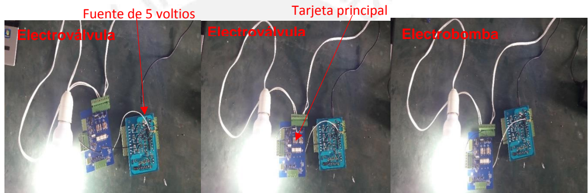
Figura 4.16: Fotografías de las pruebas a los excitadores de elementos de potencia.
