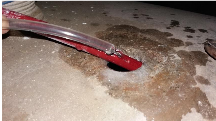
Figura 4.14: Chorro de agua arrojado al orificio superior del tanque por el dosificador.
