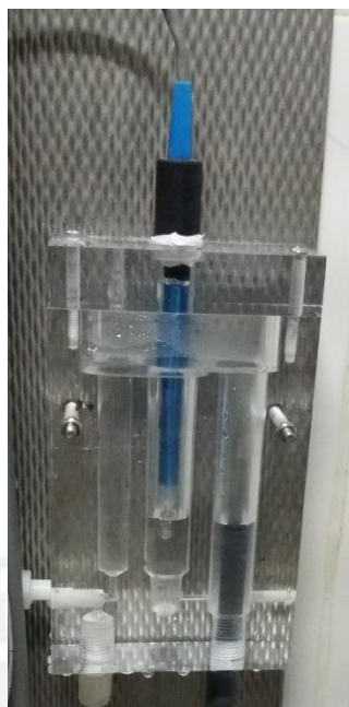
Figura 4.5: Fotografía de la celda de flujo con la sonda.
