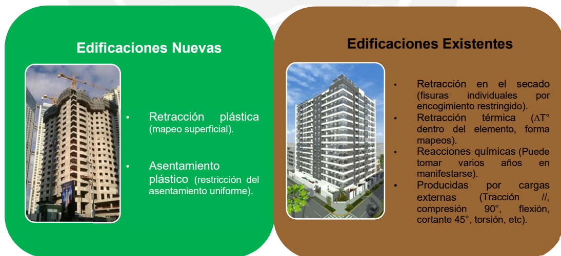
Figura 6. Causas de la Fisuración (Adaptado de Sika Argentina 2015).
