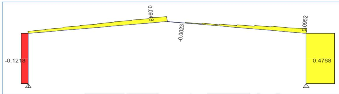
Figura 6.49 - Cargas axiales a compresión por cargas laterales de viento (t)
