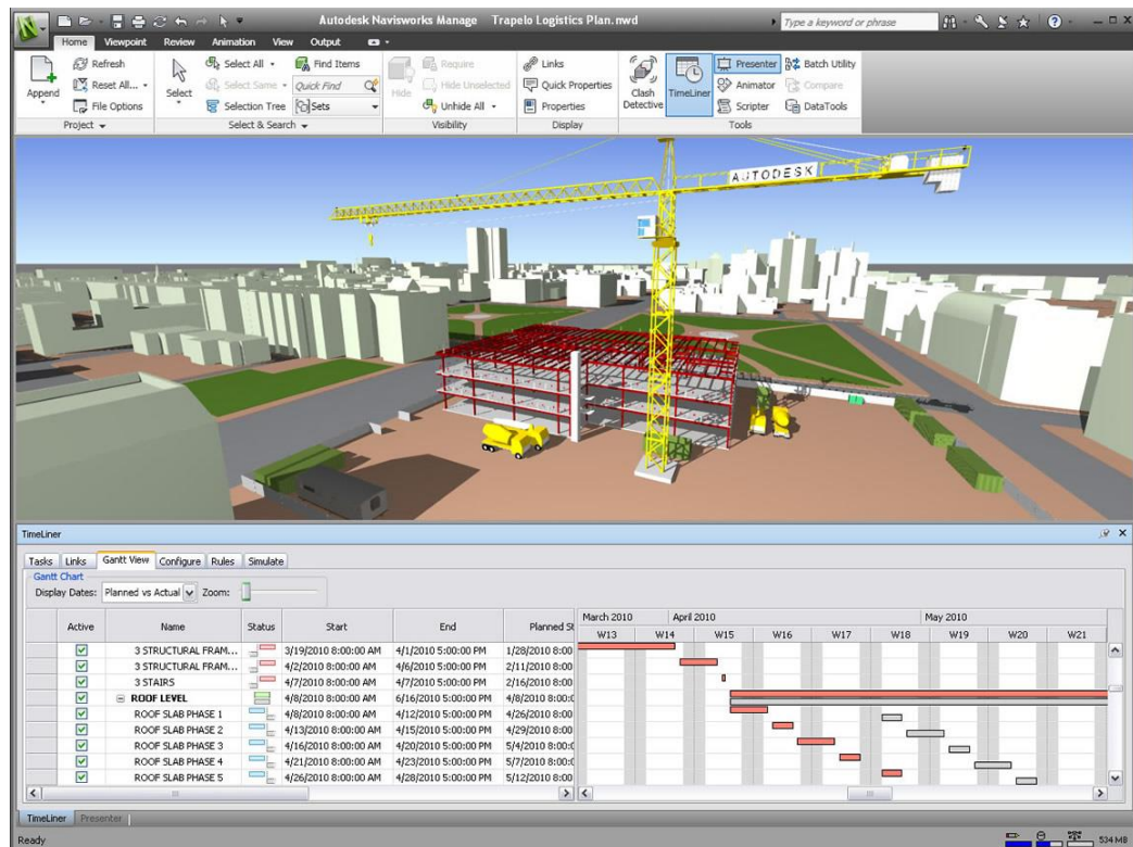
Ilustración 8. Uso de modelos 3D y 4D en la planificación y programación de obra. Fuente: https://www.autodesk.com.au/products/navisworks/features/model-simulation-and-analysis/5d-project-scheduling-includes-time-and-cost
