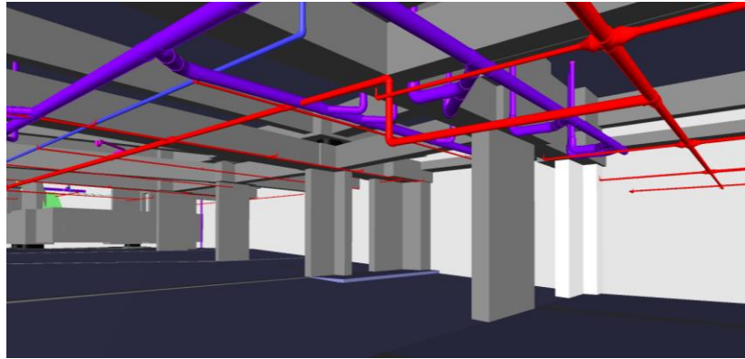
Ilustración 58 Interferencias entre sistema ACI y Red de desagüe en Sector SIII. Fuente: Propia.
