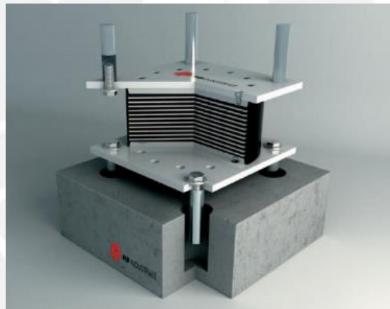
Figura 3.3. Esquema de un aislador LDRB (FIP Industriale, 2015)
