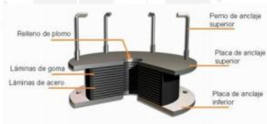
Figura 3.6. Esquema de un aislador elastomérico con núcleo de plomo. (Nunez, 2015)
