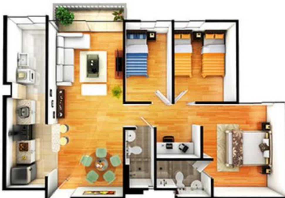
Figura 3.03.- Esquema de planta de unidad de vivienda típica de 71 m<sup>2</sup>
