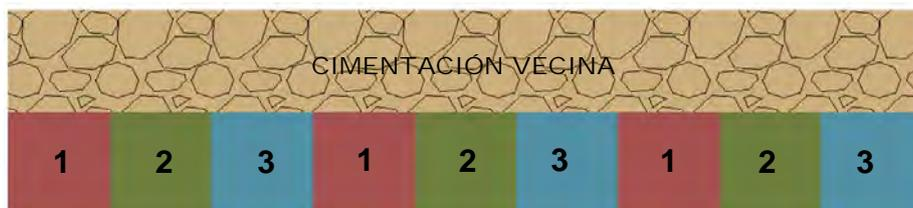
Fig 1.2: Orden recomendado para la fabricación de los bloques de una calzada.
