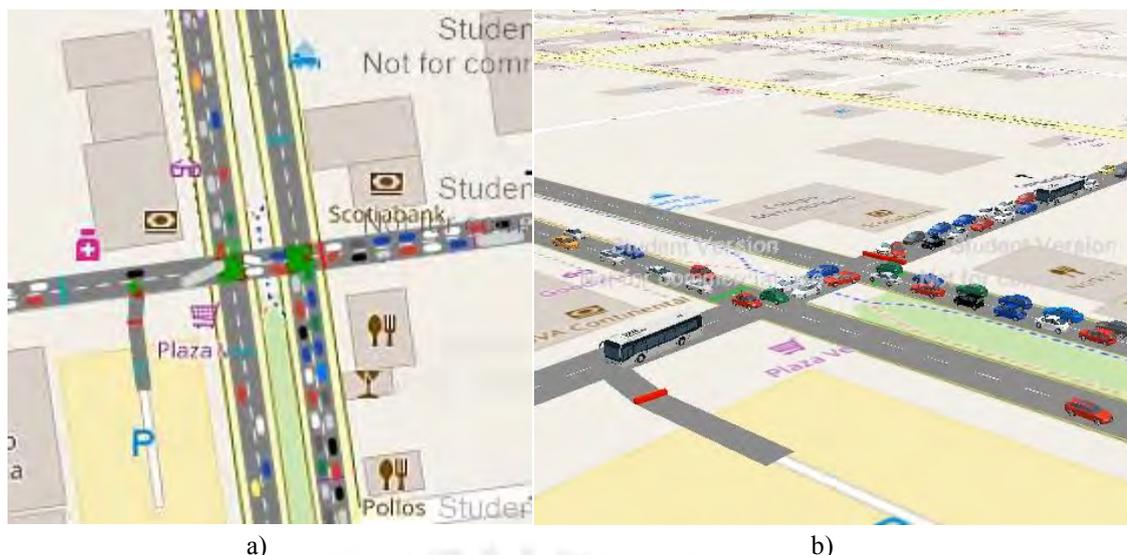
Figura 2.11: Simulación del comportamiento de una intersección convencional con tráfico intenso. a) Visualización 2D, y b) Visualización 3D
