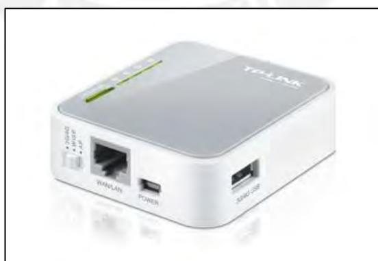
Figura 4.9: Router 3G/4G Tp-Link TL-MR3020 (TP-Link 2017c)
