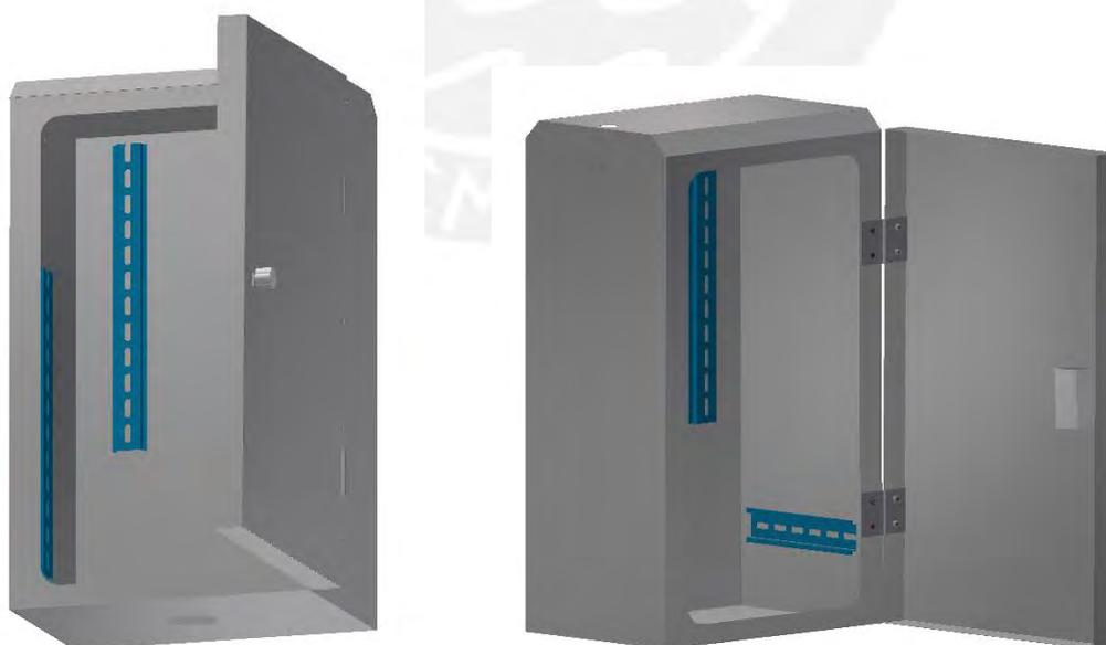
Figura 4.19: Diseño de la caja ensamblada del controlador
