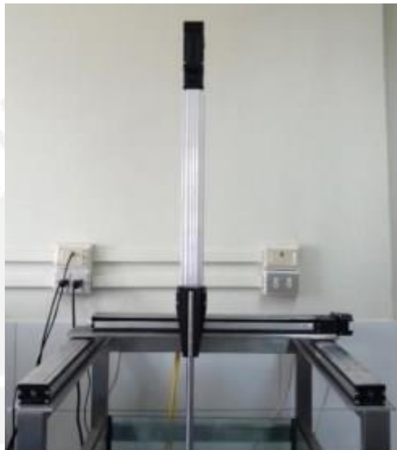
Figura 6.2. Sistema posicionador de 3 ejes, con el cual se puede realizar la adquisición de señales RF.
