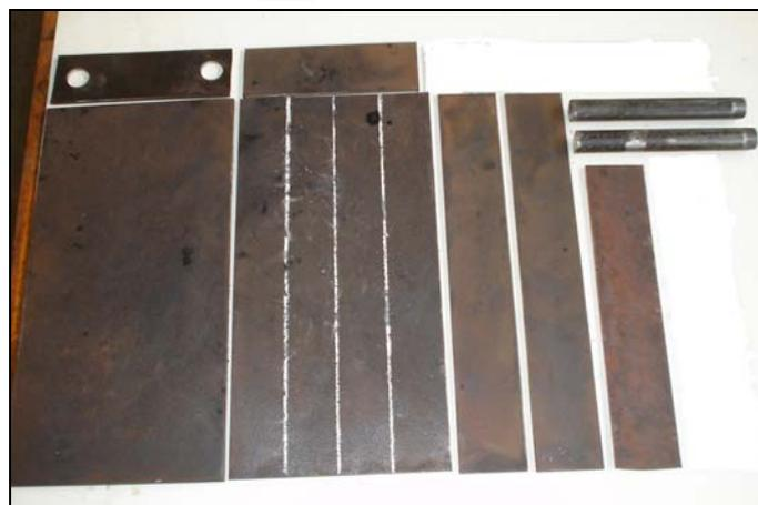
PLANCHA DE ACERO DESPUÉS DEL CORTE
