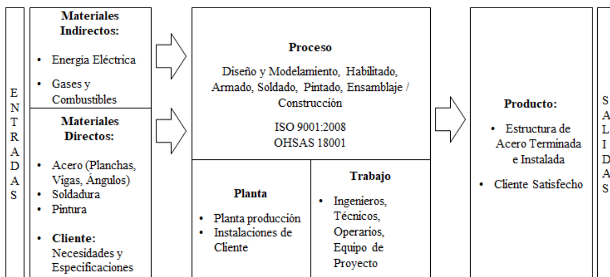
Figura 4. Diagrama básico entrada–proceso-salida de operaciones productivas de Metalikas. Adaptado de Administración de las Operaciones Productivas (p. 9), por F. A. D’Alessio, 2012, México D.F., México: Pearson.
