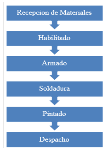
Figura 31. Secuencia de los procesos de fabricación de los componentes de las estructuras metálicas.
