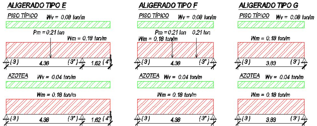
Figura No. 03 - 03.- Cargas sobre losas aligeradas tipos E, F y G para los pisos típicos y la azotea
