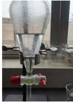
Figura 2.22.a. PBS agitando con el scaffold mientras se va liberando el fármaco; b. Separación del fármaco de la fase acuosa con cloroformo; c. Muestras preparadas para lectura UV
