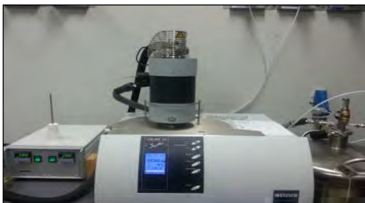
Figura 2.10. Equipo TGA NETZSCH STA 449 F1 Júpiter® del CITE.
