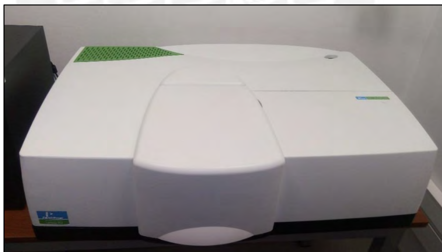
Figura 2.14. Espectrofotómetro Lambda de doble haz de luz
