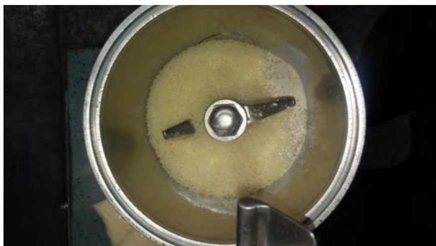
Figura 2.16. Mezclado de pellets de PLA y PEG.
