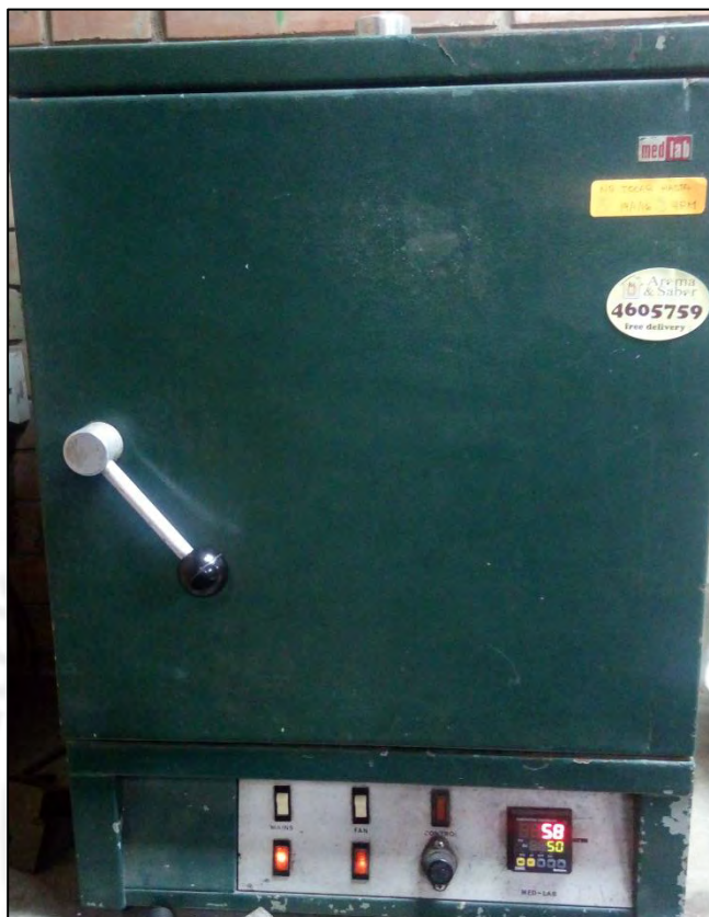
Figura 2.2. Horno de convección del laboratorio 4
