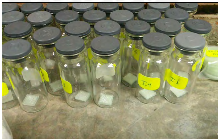
Figura 2.20. Ensayos de degradación en fluido corporal simulado (SBF)
