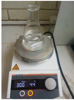
Figura 2.22.a. PBS agitando con el scaffold mientras se va liberando el fármaco; b. Separación del fármaco de la fase acuosa con cloroformo; c. Muestras preparadas para lectura UV
