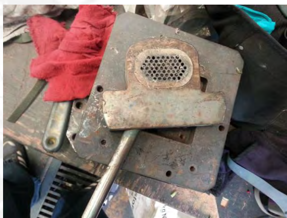
Figura 2.1. a. Extrusora de doble husillo; b. Bomba de vacío; c. Plato rompedor
