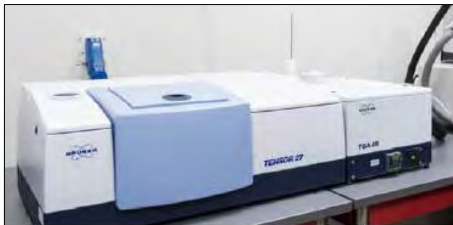
Figura 2.9. Equipo FTIR del laboratorio CITE de la PUCP
