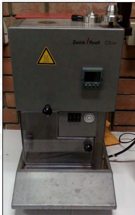
Figura 2.8. Equipo MFI laboratorio 4 de mecánica.
