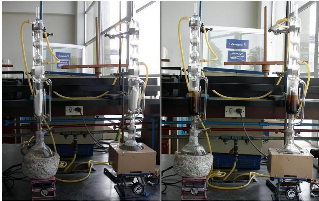
**Foto 6:** Pre-tratamiento de la borra de café mediante equipo Soxhlet.
