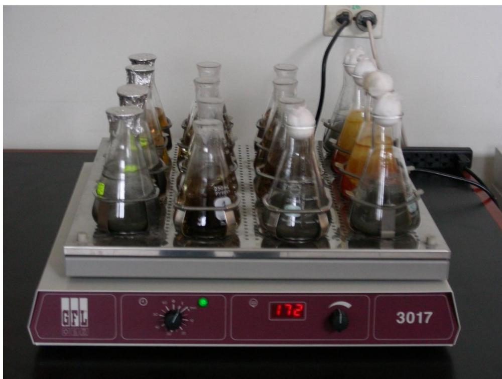
**Foto 7:** Pruebas de adsorción con el agitador orbital GFL 3017.
