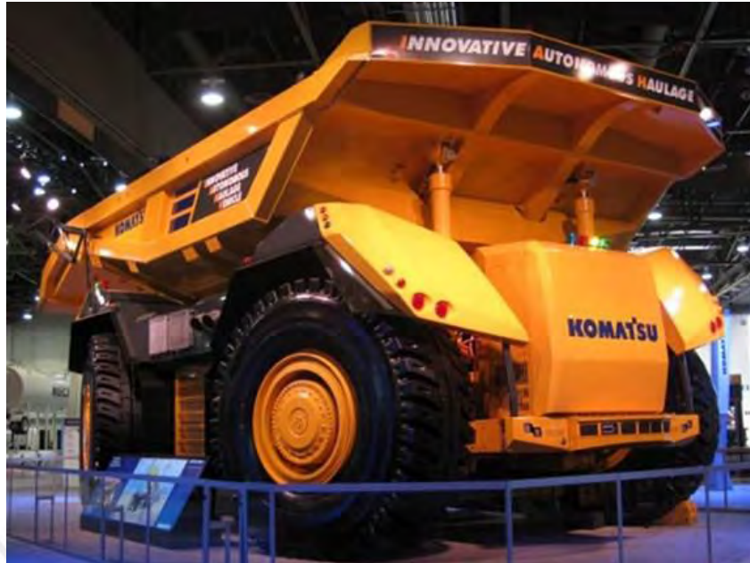
Figura 28. Camión Komatsu autónomo (sin conductor) para operaciones de superficie Recuperado de https://www.tradeearthmovers.com.au/product-news/1610/komatsu-debuts-driverless-haul-truck-at-minexpo2016
