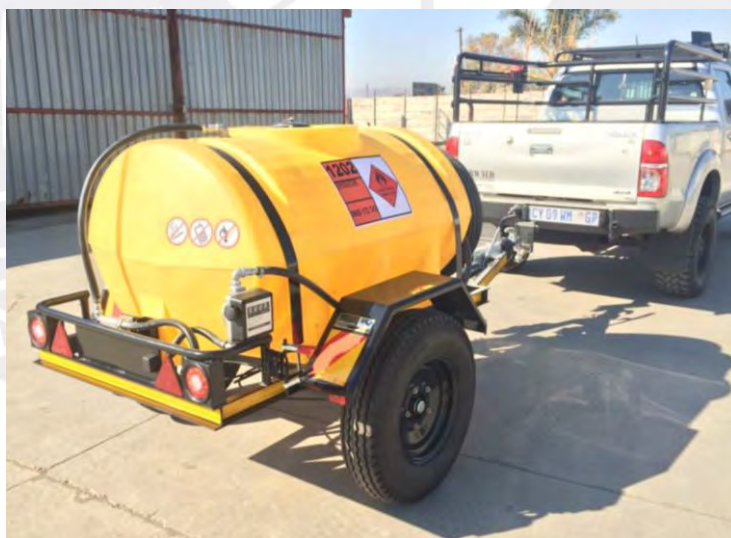
Figura 46. Tráiler de diésel típico de interior mina. Recuperado de http://www.arwald.co.za/tankers-and-trailers/
