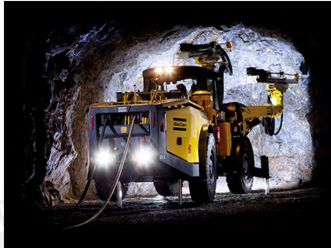
Figura 27. Jumbo de dos brazos. Tomado de Minería Sostenible: Principios y Prácticas (1ra ed.) por J. Oyarzun & R. Oyarsun, 2011, La Serena – Madrid: GEEM
